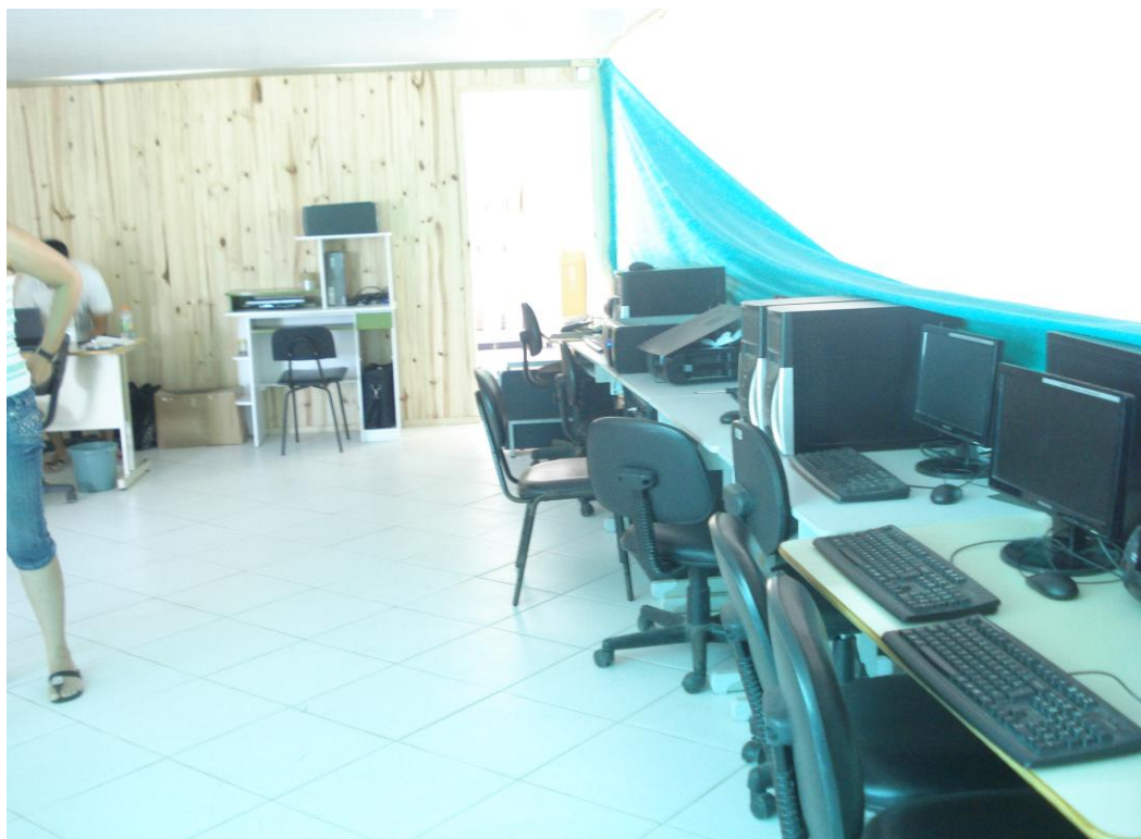
Sala informatizada com excesso de claridade e extremamente abafada, causando a queima de computadores
