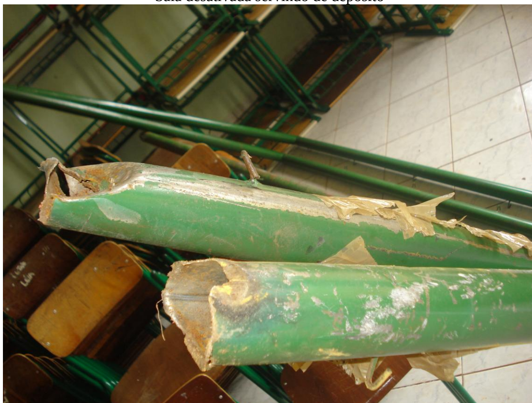
Trave de futebol com apenas 03 meses de uso quebrada
